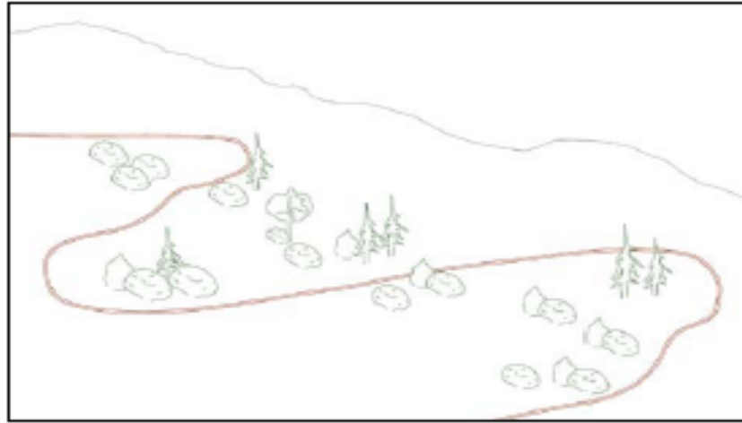
Σχήμα 3.2. Διαδρομή με λιγότερες και ομαλοποιημένες στροφές (πιο σωστή) (Πηγή: Οδηγός δημιουργίας και διαχείρισης δασικών μονοπατιών στην Κύπρο, 2011)
