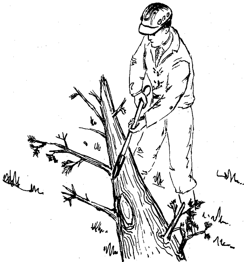
Σχ. 49. Ἡ ὀρθὴ θέσις δι' ἀποκλάδωσιν. Ἡ ἀσφαλεσιότατη πρακτικὴ εἶναι τὸ νὰ ἴσταται ὁ ἐργάτης εἰς τὴν πλευρὰν ἐκείνην τοῦ δένδρου, τὴν ἀντίθετον τοῦ κλάδου, ὁ ὁποῖος ἀποκόπτεται.
