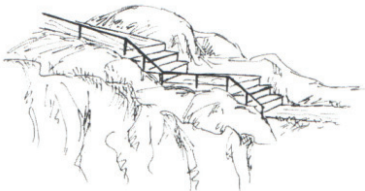
Εικόνα 12: Κατασκευή σκάλας με πλατύσκαλα και τοποθέτηση προστατευτικού κιγκλιδώματος σε επικίνδυνα σημεία
