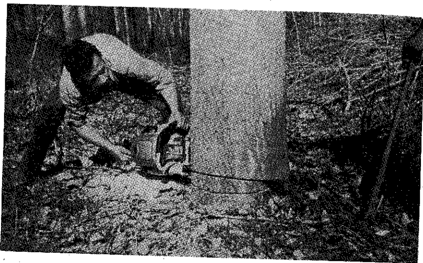
Είκ. 30.—Υλοτομία λευκάν με μηχανοκίνητο άλυσσοπρίωνο. (Φωτ. 'Ι. Γαρυφάλου)
