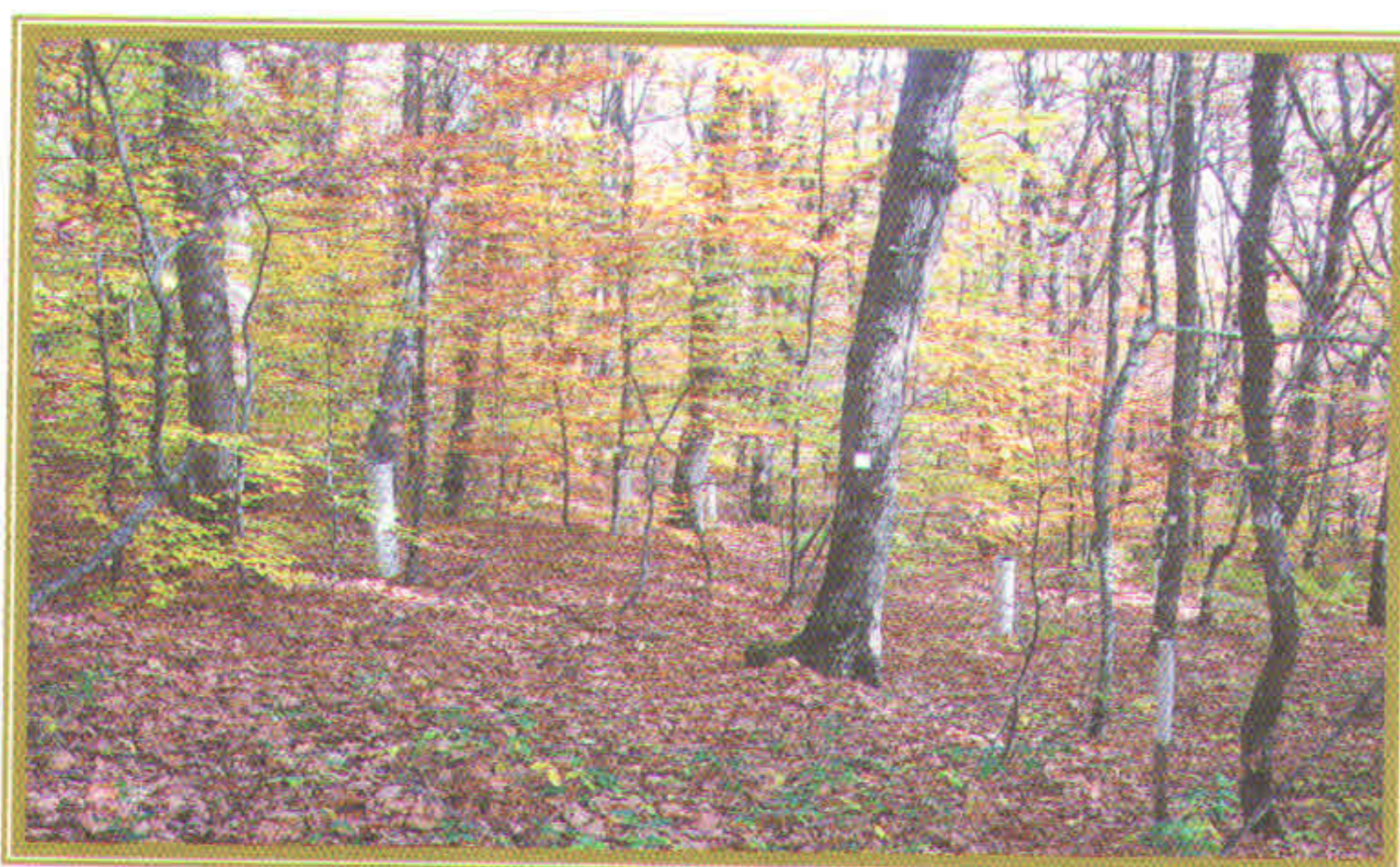
Εικόνα 4. Μέτρηση διαπερώσας βροχής σε συστάδα δρυός. Η υδατοσυγκράτηση ισούται με τη διαφορά συνολικής και διαπερώσας βροχής
