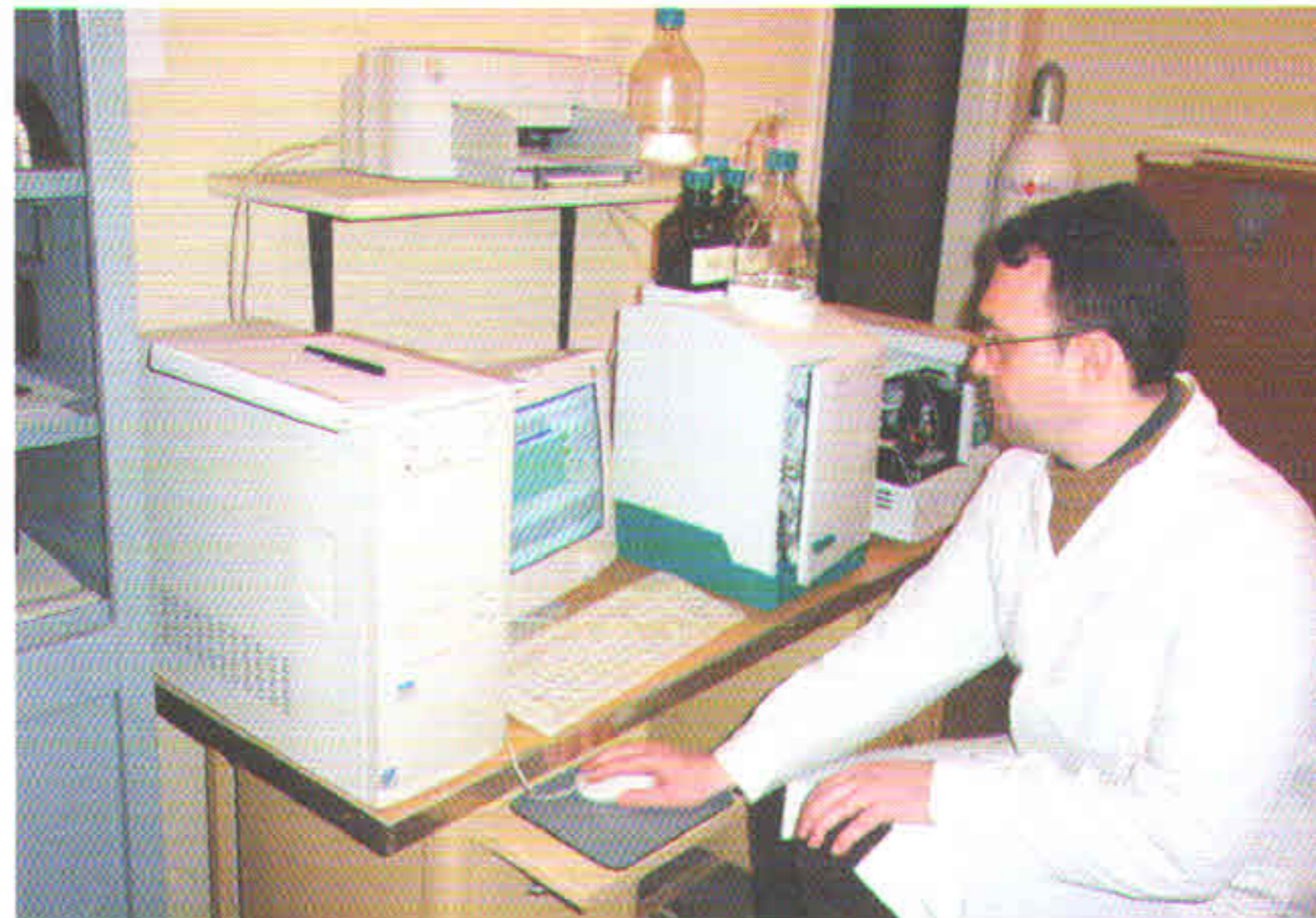
Εικόνα 22. Προσδιορισμός συγκεντρώσεων ανιόντων σε δείγματα νερού με ιοντικό χρωματογράφο.
