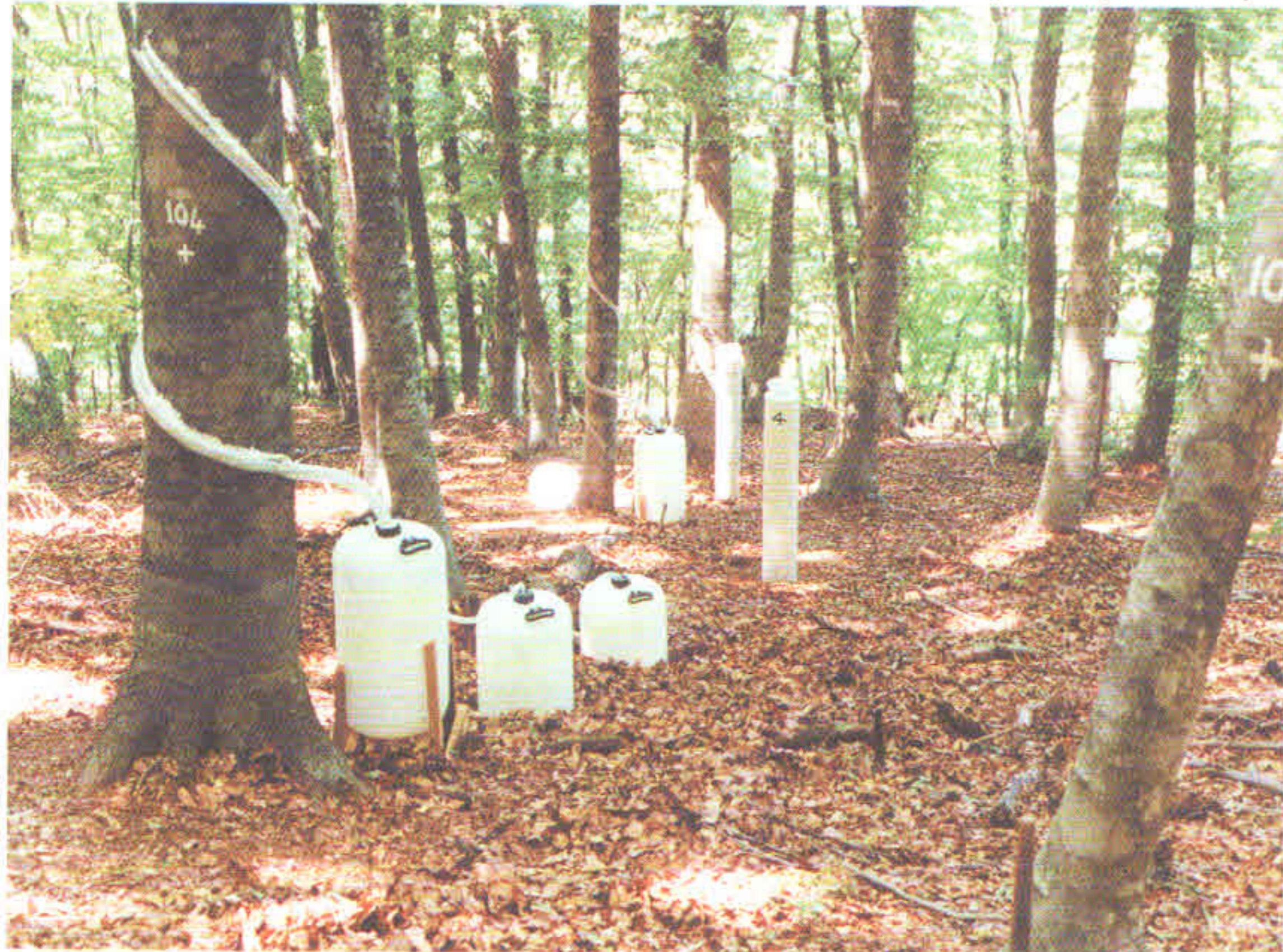
Εικόνα 24. Μέτρηση και συλλογή κορμοαπορροής και διαπερώσας βροχής για χημική ανάλυση.
