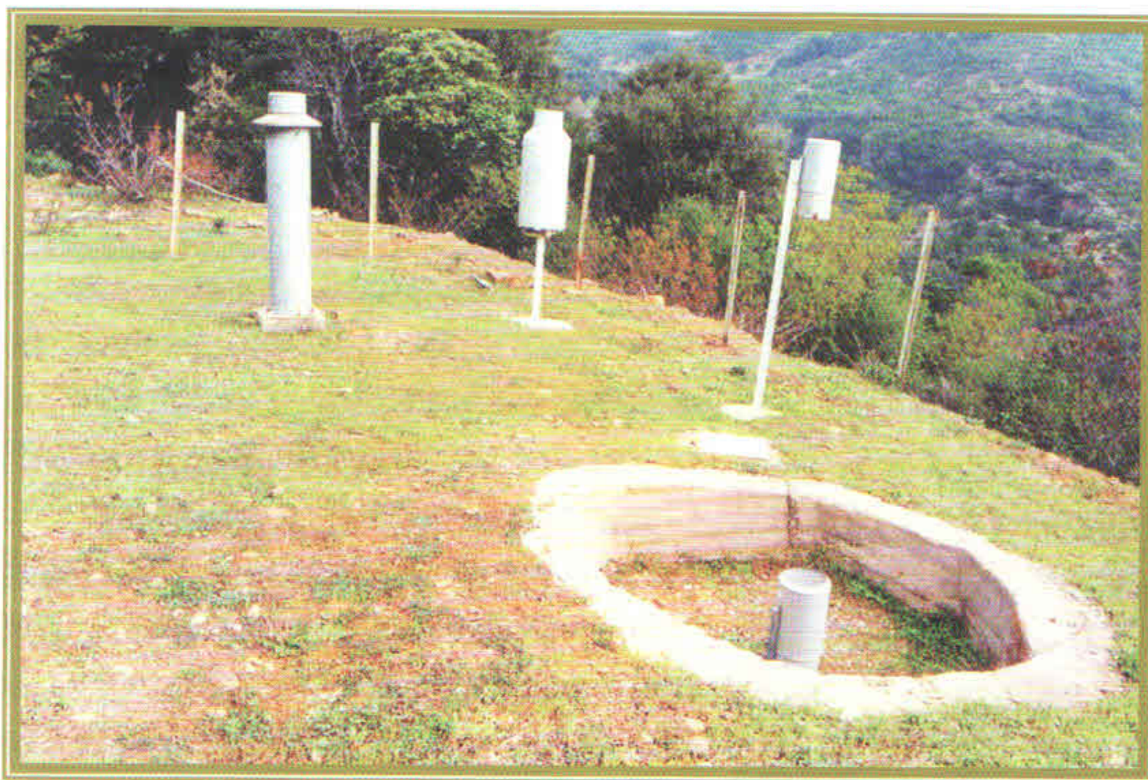
Εικόνα 6. Λειτουργία βροχομέτρου επιφάνειας εδάφους για την εκτίμηση του σφάλματος μέτρησης της βροχής σε διαφορετικό ύψος.
