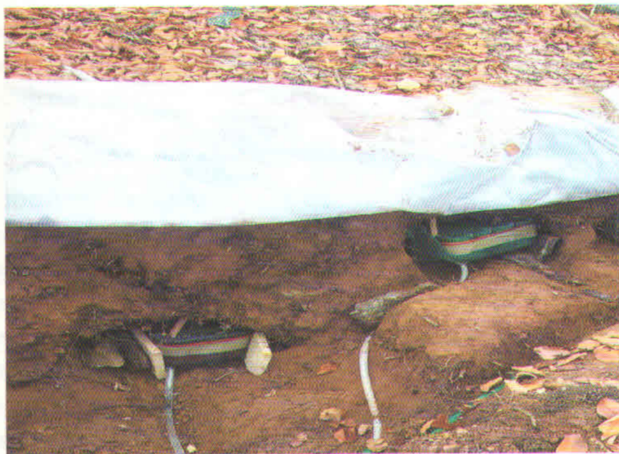
Εικόνα 25. «Λυσίμετρα» για συλλογή και χημική ανάλυση εδαφικού διαλύματος.
