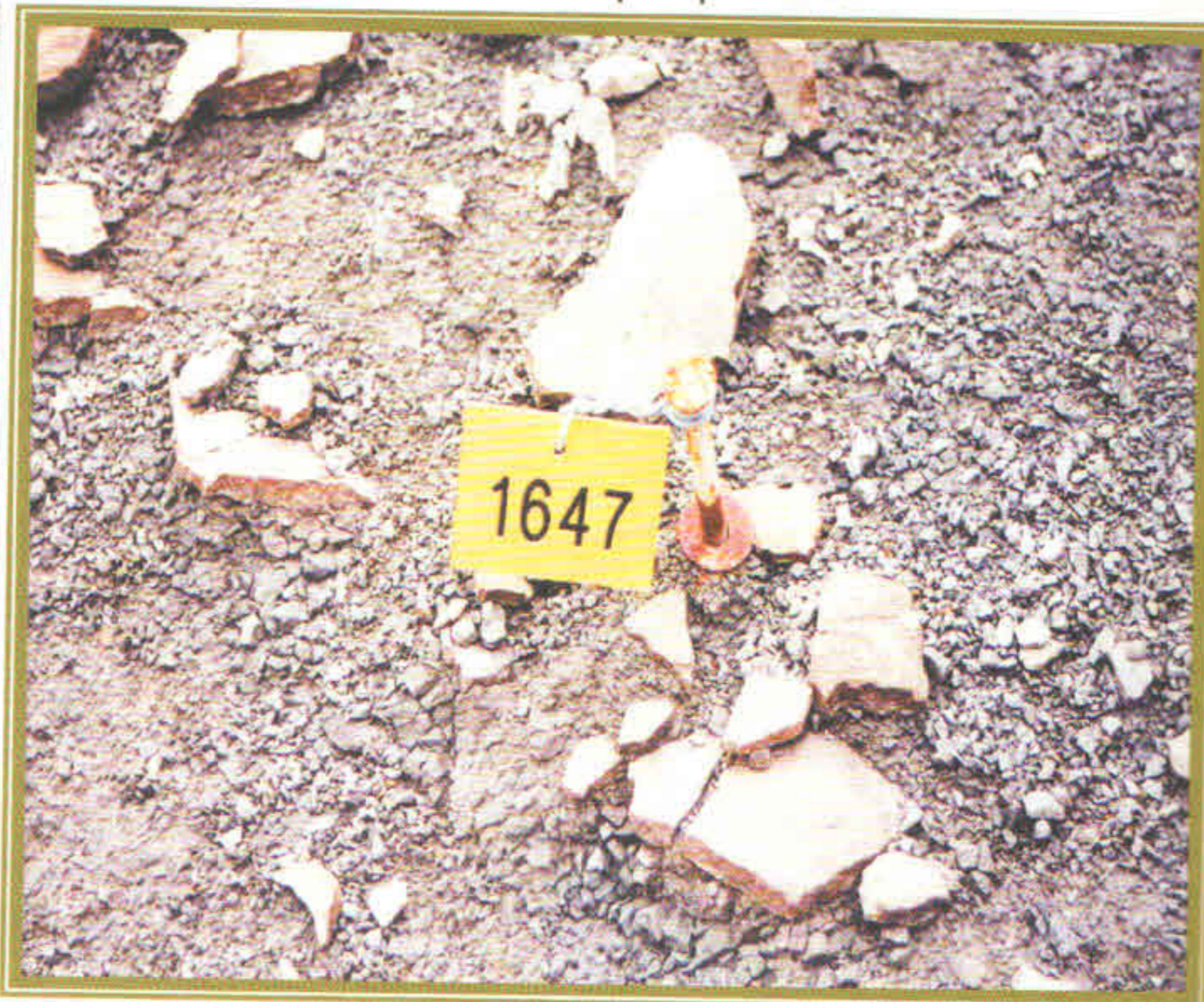
Εικόνα 14. "Δείκτης" εκτίμησης της διάβρωσης του εδάφους σε γυμνή από βλάστηση θέση του φλύσχη της δυτικής Ελλάδας.
