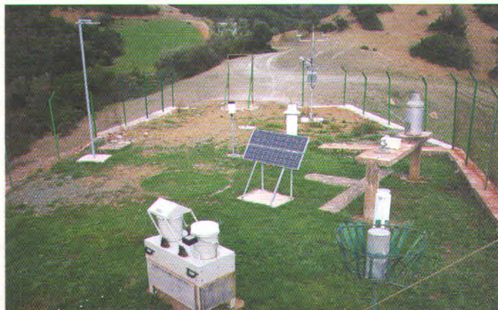
Εικόνα 23. Πλήρης μετεωρολογικός σταθμός σε δάσος αιφύλλων πλατυφύλλων της Δυτικής Ελλάδας όπου μετράται και συλλέγεται η βροχή για χημική ανάλυση.
