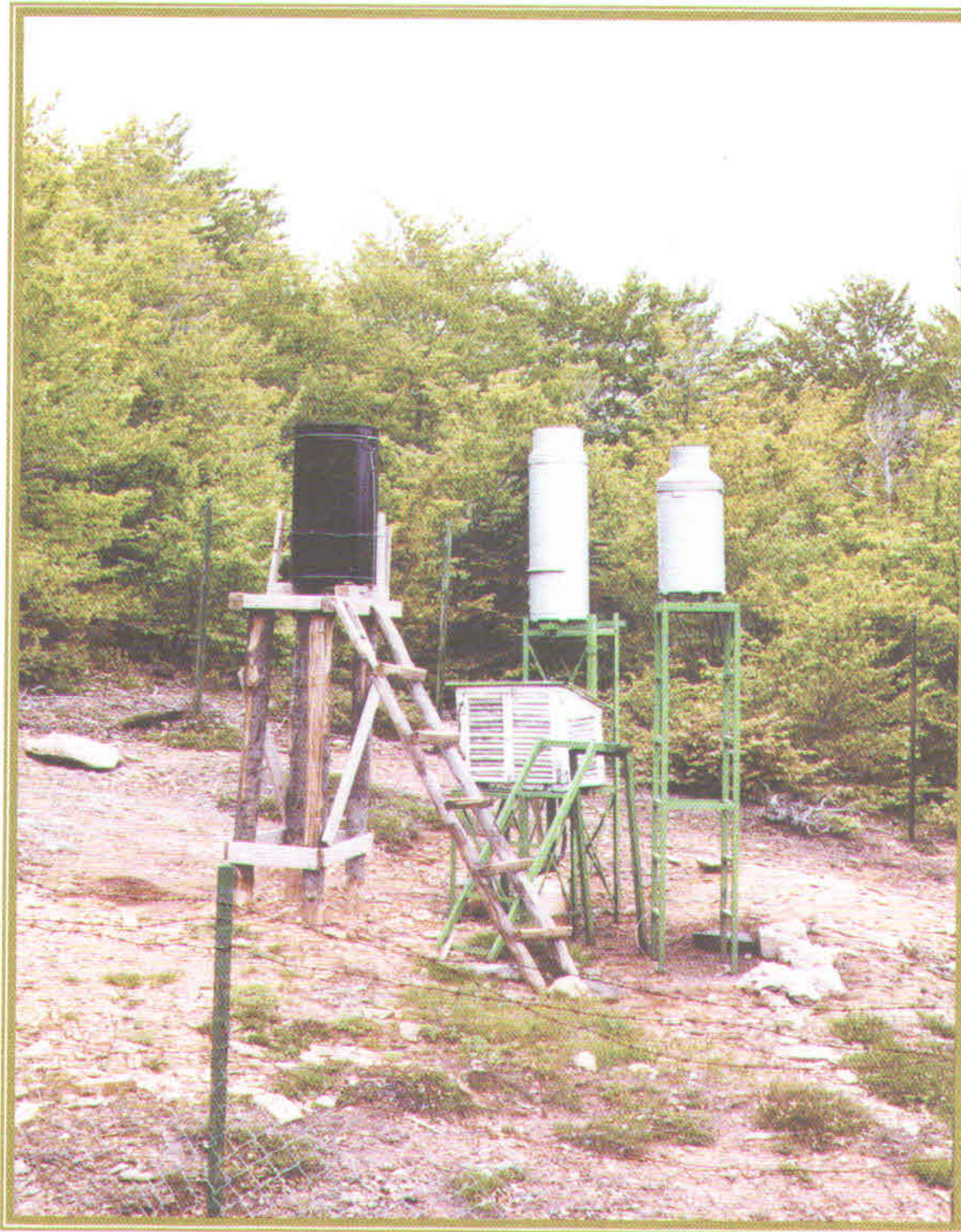
Εικόνα 7. Βροχογράφοι και βροχόμετρο (μαύρο) συνολικής καταγραφής και χωρητικότητας 300, 750 και 1000 χιλιοστών αντίστοιχα.
